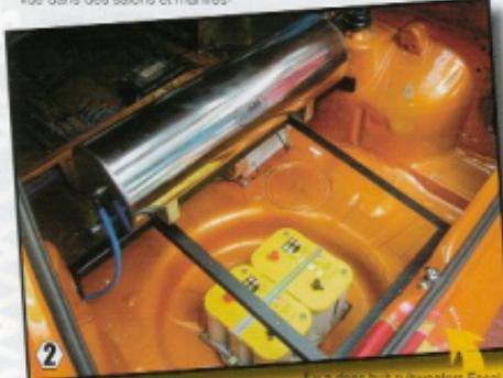
2 Il y a donc huit subwoofers Focal prévus dans le coffre. Ce sont des 13KS, c'est-à-dire d'un diamètre de 13 cm chacun. Ils seront montés à l'envers (châssis apparent). Tous nécessitent un cadre, pour être non seulement très soigneusement fixés mais aussi parfaitement orientés. Pour cela, Julio a utilisé une décalcomanie pour travailler directement les perneaux de particules (bois aggloméré).
