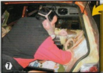
Comme nous l'avions déjà vu dans les précédents montages, des caches en bois permettent de protéger parfaitement les orifices et de maintenir propres les futurs orifices de fixation des haut-parleurs.
